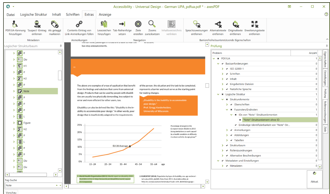
Abbildung 75: Fehler "'Note'-Strukturelement ohne ID"
